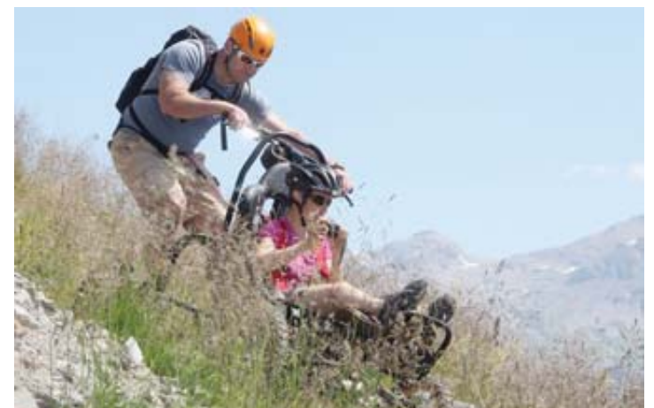
Une ligne de vie relie le pilote à son passager. Si le premier chute, le Cimgo freine automatiquement des quatre fers. LE NOUVELLISTE
